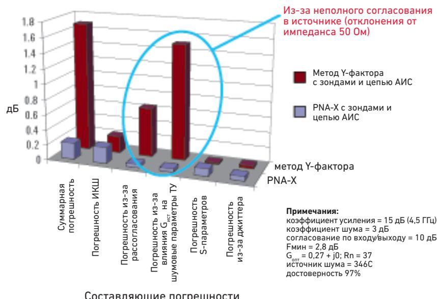
Рисунок 19 - Распределение составляющих погрешности для примера определения погрешности измерения коэффициента шума на зондовой станции.
