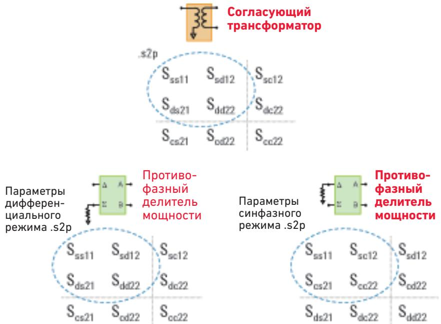
Рисунок 36 - Выбор 4-х соответствующих параметров дифференциального или синфазного режима.
