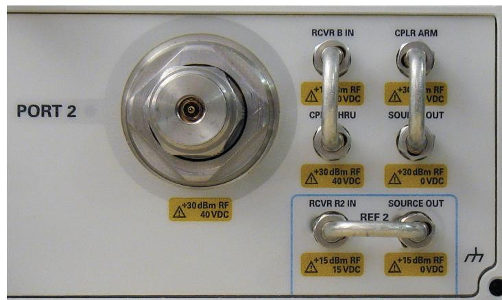
Рисунок 30 - Размещение кабельных перемычек для включения направленного ответвителя измерительного порта в обратном направлении (прямой и ответвленный каналы поменялись местами).
