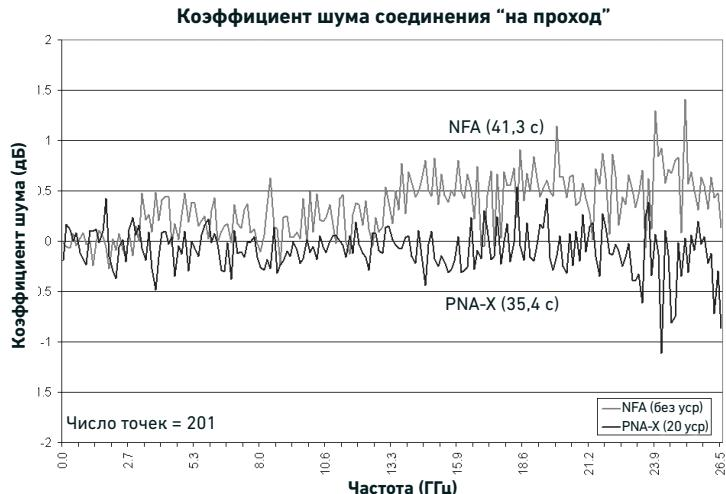
Рисунок 45 - Сравнение результатов измерения соединения “на проход” при использовании PNA-X с малошумящими приёмниками и NFA.
