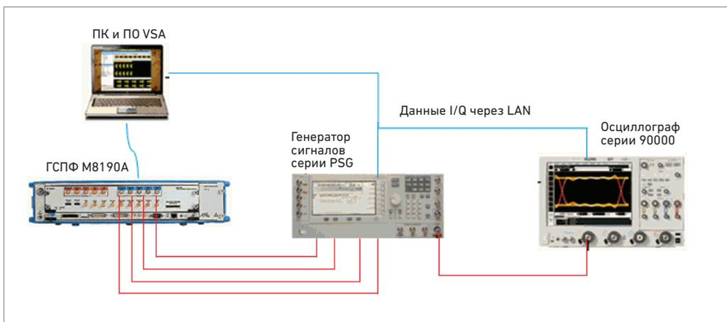
Рисунок 5. Конфигурация системы для испытательной платформы сверхширокополосной РЛС
