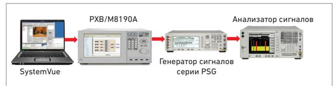
Рисунок 1. Конфигурация системы генератора радиолокационной цели
