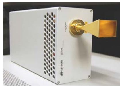
Рисунок 4. Сверхширокополосный понижающий преобразователь миллиметрового диапазона компании Keysight Technologies. В правой верхней части виден волноводный вход с рупорной антенной. Этот понижающий преобразователь использует сигнал внешнего СВЧ-гетеродина, а его выходной сигнал подается на внешний дискретизатор, например, на осциллограф.
