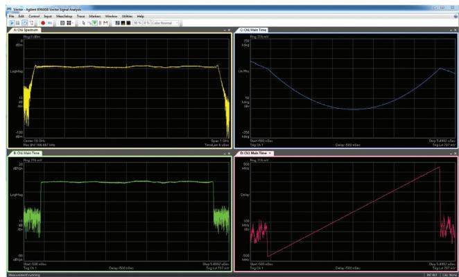
Рис. 6. Пример демодуляции радиолокационного ЛЧМ-сигнала частотой 750 МГц
