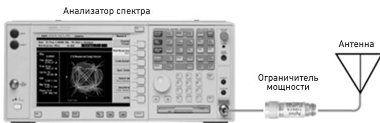
Рис. 2. Типичное использование ограничителя мощности для защиты ВЧ прибора. Вход анализатора спектра защищен от непреднамеренной перегрузки при поступлении сигналов высокого уровня от антенны.
