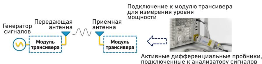
Рис. 3. Активный дифференциальный ВЧ пробник можно использовать для поиска неисправностей в ВЧ и СВЧ схемах. Такое решение позволяет повысить точность измерений за счет увеличения динамического диапазона прибора.
