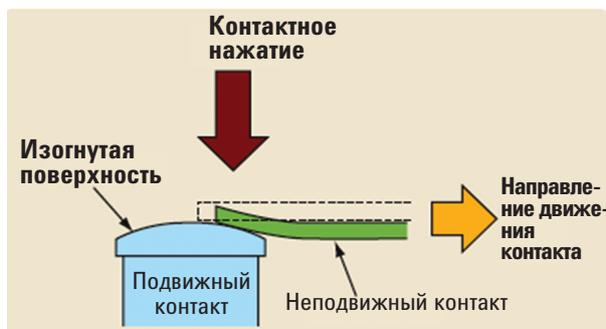
Рис. 1. В электромеханическом реле Keysight используется запатентованная конструкция с изогнутым подвижным контактом, который при замыкании трется о криволинейную поверхность неподвижного контакта. За счет этого трения контакты самозачищаются. Это обеспечивает стабильность вносимых потерь, составляющих 0,03 дБ в течение всего срока службы реле Keysight, что гарантирует воспроизводимость результатов измерений.
