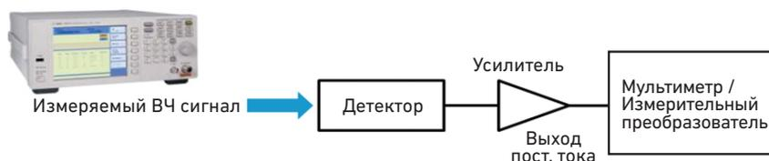
Рис. 4. Простая блок-схема измерения мощности. Предложенный метод измерения мощности может быть также использован за пределами квадратичной области характеристики детектора, поскольку изменения этой характеристики повторяются и прогнозируются для детекторных диодов каждого типа. Компенсация любых нелинейностей выполняется под управлением компьютера.
