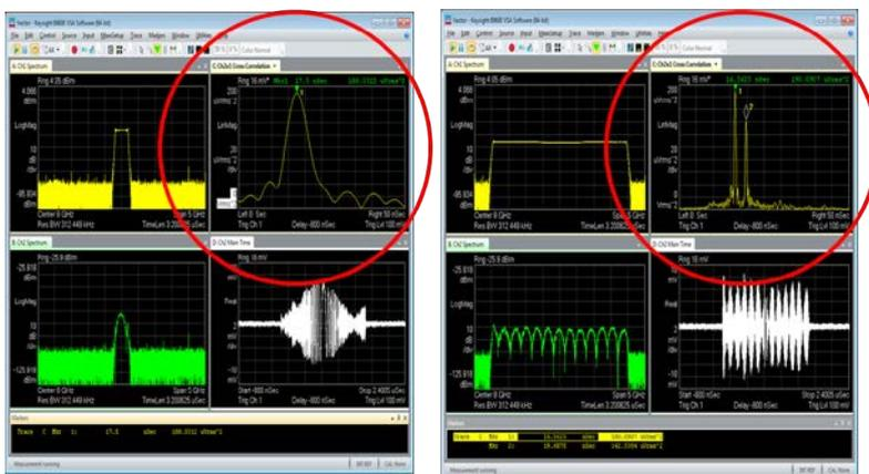
Рис. 2. Сравнительное испытание радаров с разной полосой: радар с полосой 4 ГГц (справа) обнаружил два разделенных объекта на расстоянии всего 10 см друг от друга.
