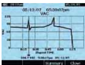
Просмотр записанных данных в графическом виде на дисплее
