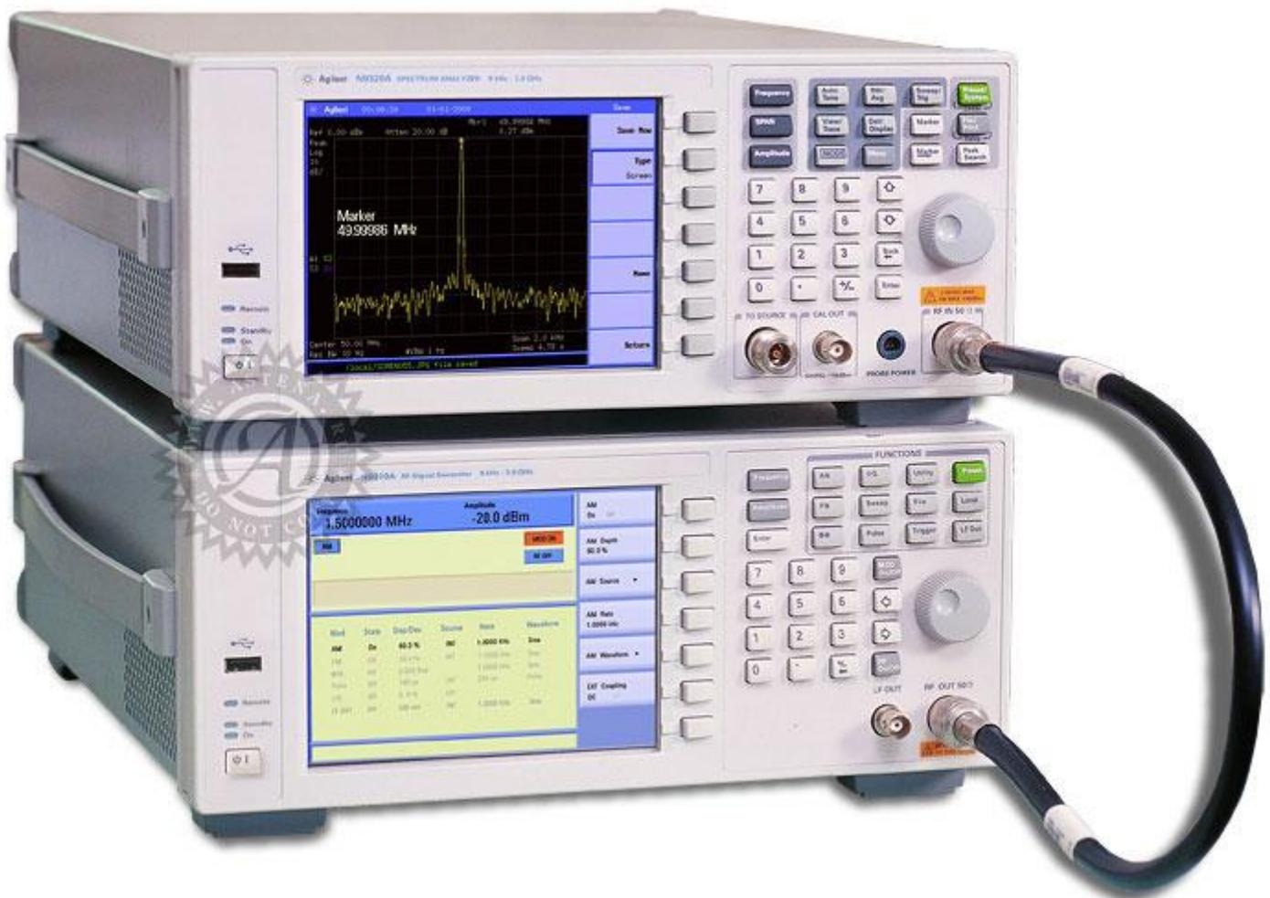
Анализатор спектра N9320B вместе с генератором сигналов N9310A
