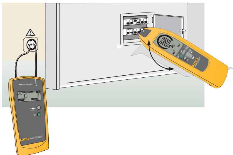
Рис. 3 - Пример использования, обнаружение пролегания электрических цепей до защитных устройств без отключения системы
