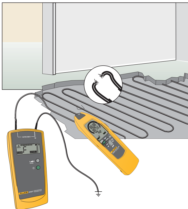
Обнаружение повреждений в электрических системах теплых полов
