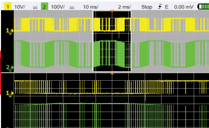
Превосходные возможности масштабирования. Глубокая память и высокая частота дискретизации позволяют захватывать длинные фрагменты и неповторяющиеся сигналы, а затем растягивать участки осциллограммы для детального изучения.
