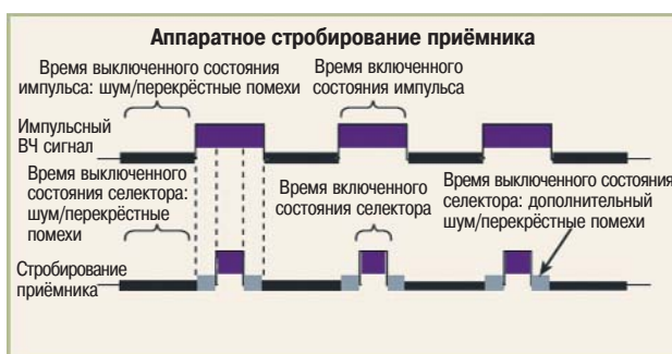
Рисунок 4 - Метод аппаратного стробирования приёмника
