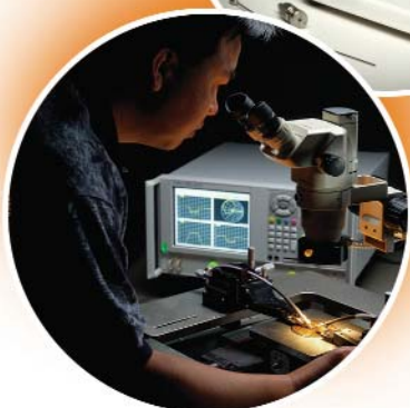
Зондовые измерения компонентов на пластинах
