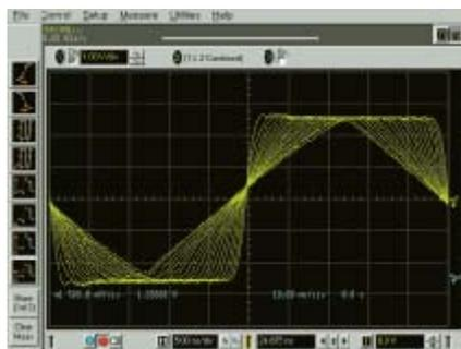
Возможность изменения времени перепада от 5 нс до 200 мс помогает проводить испытания схем на чувствительность, синхронизацию и другие критичные факторы.
