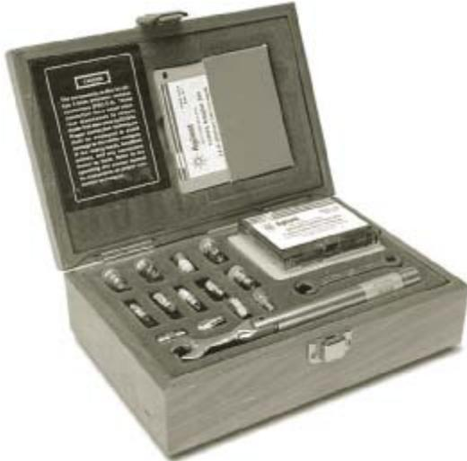
Переходы могут служить для защиты соединителей от механического износа или использоваться для изменения типа или пола соединителя, обеспечивая максимальную гибкость калибровки. Возможность определения параметров пользователем можно также использовать для удобства подключения модуля ECal к устройству подключения (держателю) или зондовой станции.
