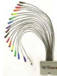
Пробники с отдельными проводниками
