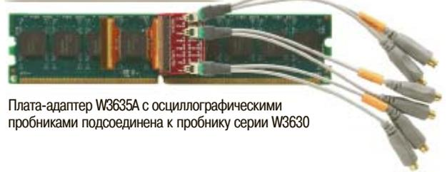
Плата-адаптер W3635A с осциллографическими пробниками подсоединена к пробнику серии W3630
