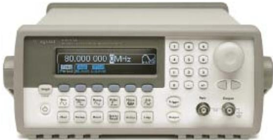
Agilent Technologies 33250A – генератор сигналов сложной формы с частотой выходного сигнала до 80 МГц, возможностью генерации импульсного сигнала и сигналов произвольной формы. Генератор построен на основе прямого цифрового синтеза формы колебаний. Сочетание свойств автономного и системного прибора делает этот генератор универсальным средством для удовлетворения требований к испытаниям в настоящее время и в будущем.
