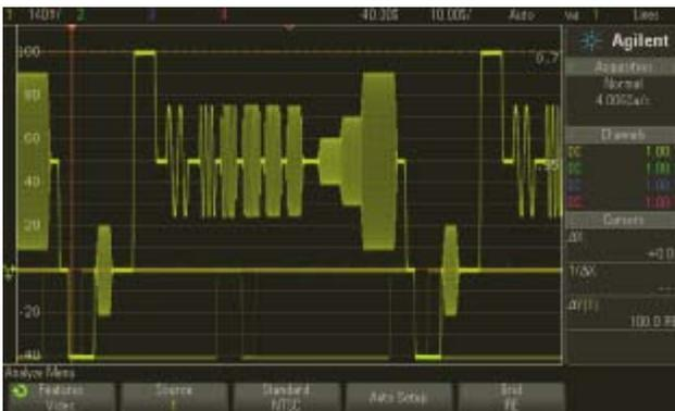
Начиная с версии программного обеспечения 2.0, осциллографы серии 3000X поддерживают шкалу IRE и курсорные измерения с использованием единиц IRE для стандартов NTSC и PAL. Эта новая возможность теперь является стандартной в осциллографах серии 3000X.
