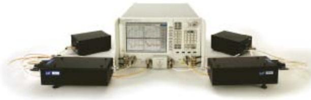
Модули расширения частотного диапазона до 1,1 ТГц компании Virginia Diodes Inc. подключены непосредственно к анализатору PNA-X с диапазоном частот до 50 ГГц.
