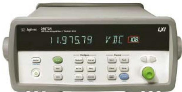
Система состоит из базового блока с тремя гнездами и встроенного цифрового мультиметра с разрешением 6,5 разрядов. Недорогой компактный блок сбора данных имеет универсальные входы со встроенной нормализацией сигналов и гибкость модульной системы. Система 34972A имеет встроенный мультиметр с разрешением 6,5 десятичных разрядов (22 двоичных разряда), базовую погрешность измерения напряжения постоянного тока 0,004% и ультранизкий уровень шума.
