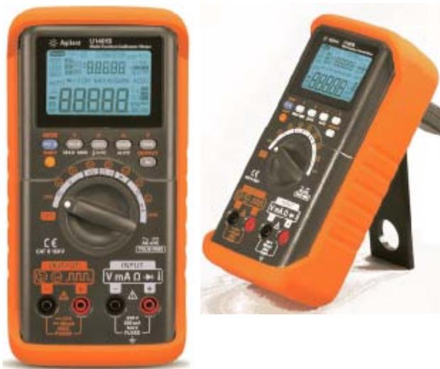
Ручной многофункциональный калибратор/измеритель U1401B компании Agilent обладает полным набором возможностей, которые необходимы для быстрого выполнения приемочных испытаний, технического обслуживания или поиска неисправностей оборудования технологического контроля. U1401B обеспечивает легкость перемещения и проведения испытаний с использованием только одного прибора с прочной конструкцией, обладающего большим количеством функций.
