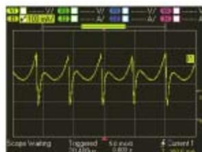
В режиме Scope View отображаются графики изменения напряжения и силы тока. На этом рисунке явно видно, что ток, вытекающий из источника питания в испытуемое устройство, имеет форму сигнала, изменяющегося со временем.
