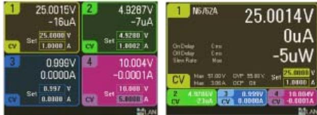
В режиме Meter View все 4 выхода можно отобразить одновременно. Для каждого выхода отображаются как измеренные значения напряжения и силы тока, так и установки мультиметра. В режиме Meter View можно также вывести увеличенное отображение одного из каналов с большим числом установок и измеренных значений. Для других трех каналов отображаются только итоговые данные.
