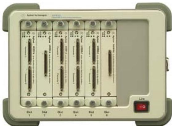
Базовый блок модульных приборов U2781A с размерами 250 мм (ширина), 177 мм (высота) и 271 мм (глубина) имеет шесть гнезд для установки модулей серий U2300A, U2500A и U2600A, а также модульных измерительных приборов U2701A/U2702A, U2722A/U2723A, U2741A, U2751A, U2761A.
