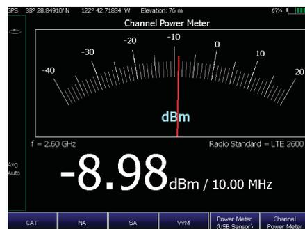
*Удобное измерение уровней мощности с помощью встроенного измерителя мощности в канале*
