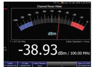
Встроенный измеритель мощности
