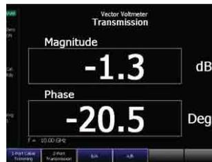
Измерения с помощью векторного вольтметра
