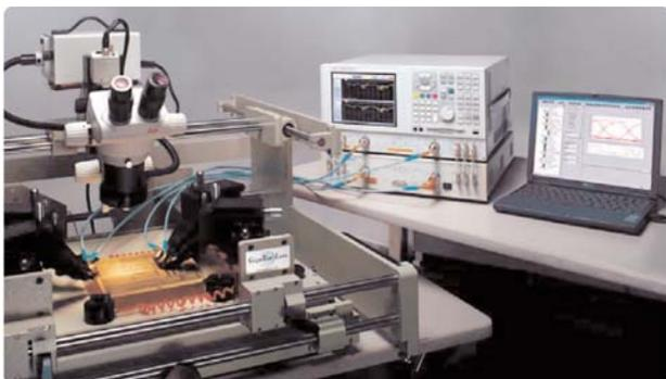
Контрольно-измерительные системы физического уровня компании Agilent обеспечивают наивысшую точность и предоставляют потребителю исчерпывающий набор инструментов для определения характеристик дифференциальных соединений, таких как высокоскоростные объединительные платы, кабели, соединители, корпуса микросхем и проводники на печатных платах с нормированным волновым сопротивлением.
