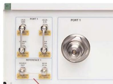
Конфигурируемый измерительный блок: доступ к трактам распространения сигналов для гибкой настройки условий измерения
