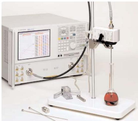
Комплект высокотемпературных диэлектрических пробников 85070E и программа для измерения параметров материалов 85071E компании Agilent позволяют упростить измерение диэлектрических свойств материалов.
