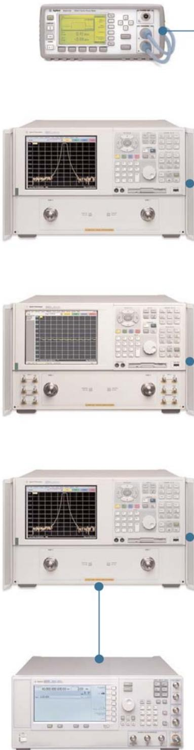
Стандартные функции и встроенная операционная система Windows предоставляют пользователю широчайший выбор средств подключения. Предусмотрена возможность использования интерфейсов GPIB, USB, LAN и параллельных соединений.
