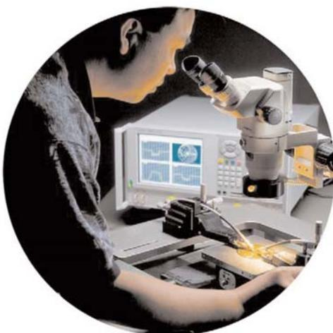
Для точных измерений на пластинах, в держателях или волноводах следует использовать калибровку вида TRL.
