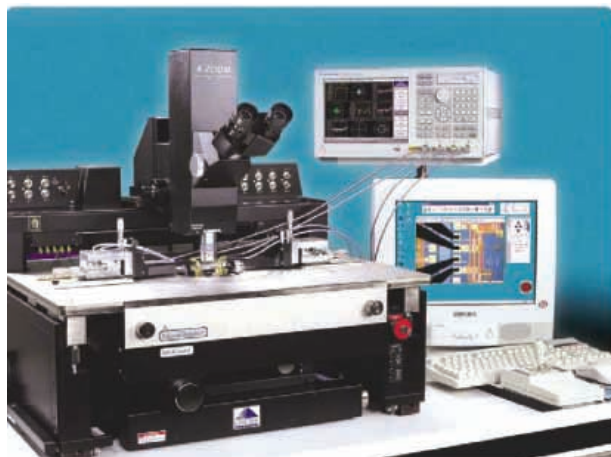
ВЧ анализатор цепей серии ENA компании Agilent и система зондовых измерений Summit 12000 Probing System компании Cascade Microtech
