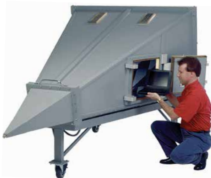
Испытательные камеры GTEM! модель 5405
