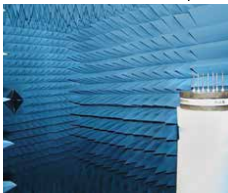
Испытательные системы AMS-8100 на базе безэховой камеры
