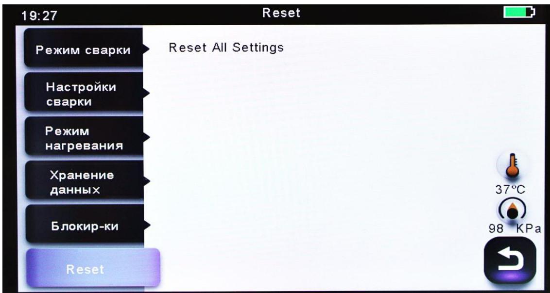
Если в работе сварочного аппарата возникла неисправность, то необходимо сбросить все параметры на заводские установки. Данная функция предназначена для специалистов сервисного центра.
