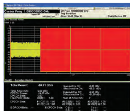
Приложение N9073A для измерения сигналов W-CDMA/HSPA
