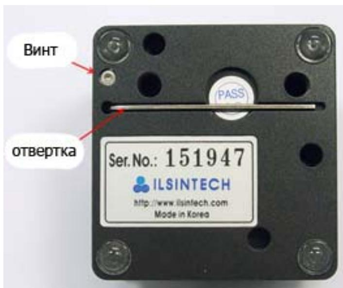
2. Ключ находится снизу на дне корпуса скальвателя, как показано на рисунке. Выньте ключ из гнезда.
