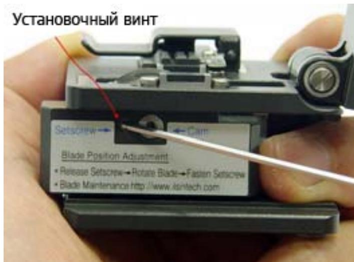
1. Ослабьте винт ключом (примерно на два оборота), придерживая каретку, как показано на рисунке.
