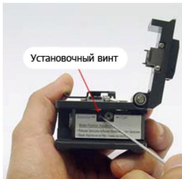
3. Ослабьте винт ключом (примерно на два оборота), как показано на рисунке.
