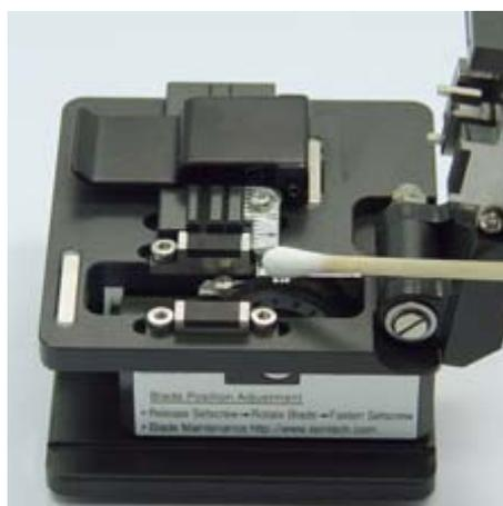
4. Поверните нож скальвателя палочкой с ватным тампоном против часовой стрелки до следующей позиции. Фиксацию ножа делают поворотом фиксирующего винта в противоположном направлении.
