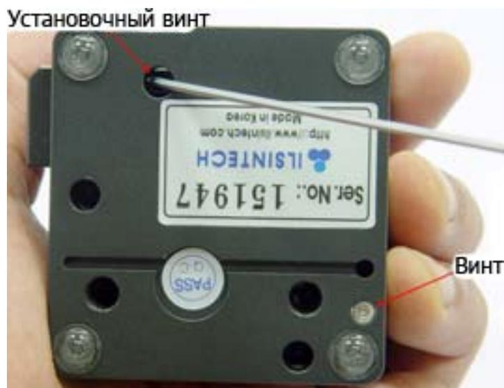
2. Ослабьте винт, находящийся на дне корпуса скальвателя (под кареткой), ключом (примерно на два оборота), в это время каретка должна быть надёжно зафиксирована, как показано на рисунке.
