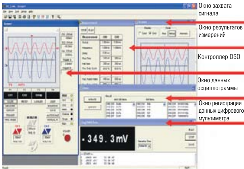
Рис. 4 ПО PC Link позволяет собирать, сохранять и документировать данные, а также дистанционно управлять прибором с ПК через полноскоростной USB порт.
