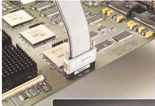
Рисунок 5 - Безразъёмные пробники Softtouch (мягкое касание) обеспечивают эффективное сочетание простого и надежного соединения с высокими характеристиками.
