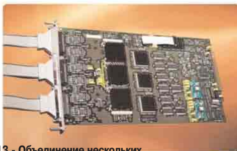
Рисунок 13 - Объединение нескольких модулей сбора данных в случае необходимости анализа большого числа каналов.
