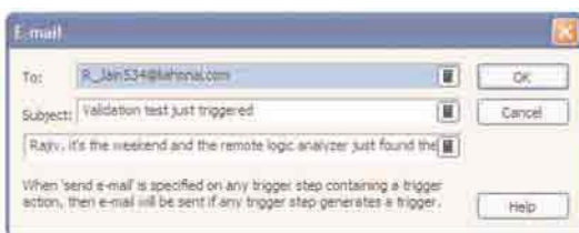
Рисунок 19 - При дистанционном управлении можно запрограммировать анализатор на посылку сообщения электронной почты, когда он обнаружит условие запуска и выполнит сбор данных, характеризующий состояние испытываемой системы.
