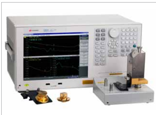
Рис. 27. Тестовая оснастка для измерения характеристик диэлектриков Keysight 16451B и 16453A с анализатором импеданса
