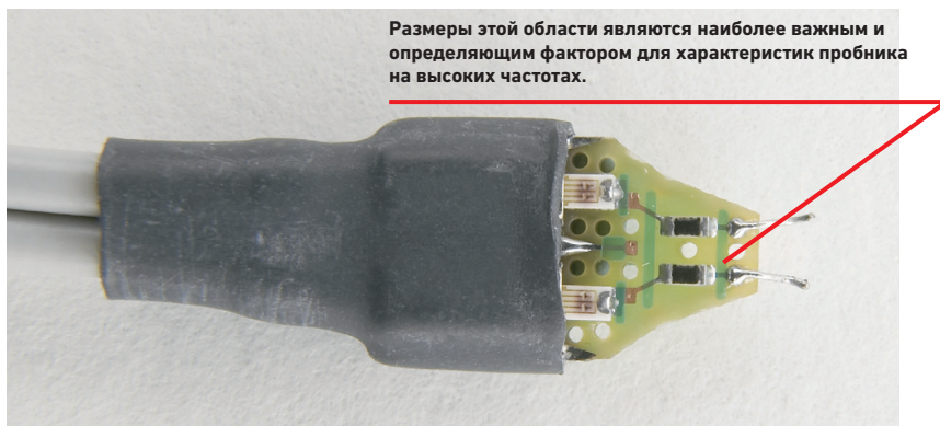
Рисунок 2. Увеличенное изображение впаиваемой головки пробника InfiniiMax
