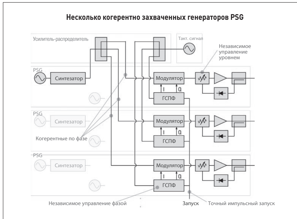
Рисунок 17. Упрощенная структурная схема когерентно захваченных и синхронизированных векторных генераторов сигнала серии PSG.
