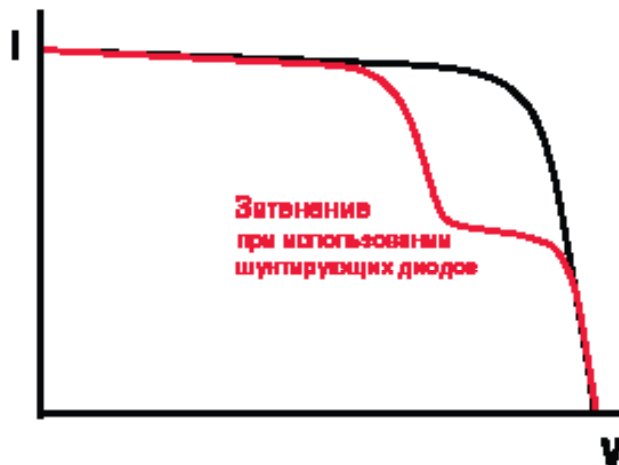
Рис. 11. Некоторые имитаторы солнечных батарей способны воспроизводить работу солнечной батареи в условиях затенения.
