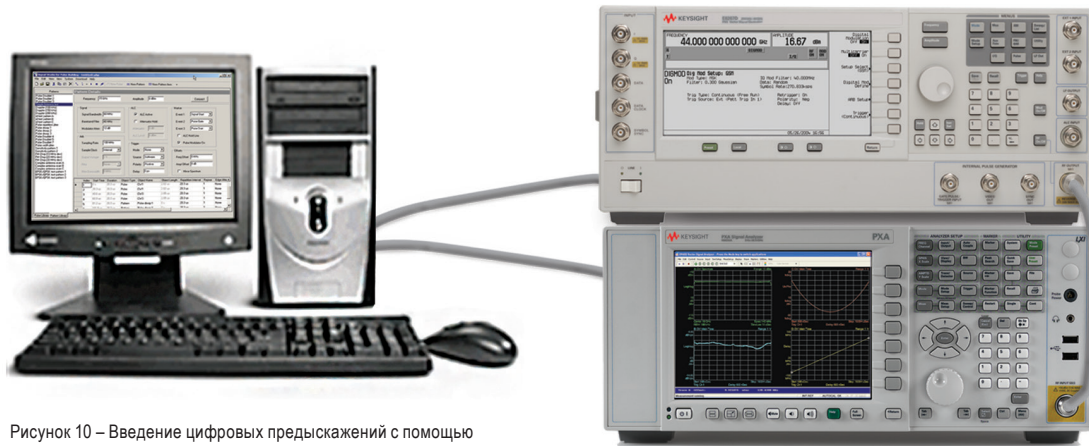
Рисунок 10 – Введение цифровых предсказаний с помощью генератора сигналов серии PSG компании Keysight
