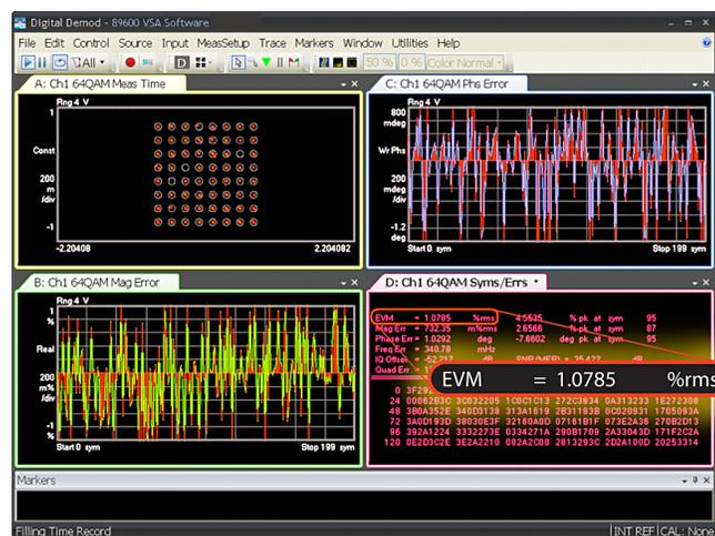
Рис. 5. Сигнальное созвездие и амплитуда вектора ошибки модулирующего сигнала 64-QAM с добавленным шумом.
