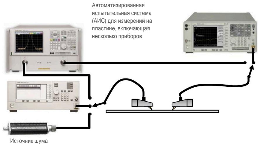
Рисунок 2 - Чем больше оборудования добавляется к конфигурации испытательной системы, тем в большей степени может пострадать точность измерения с использованием метода Y-фактора из-за ухудшения согласования в источнике.
