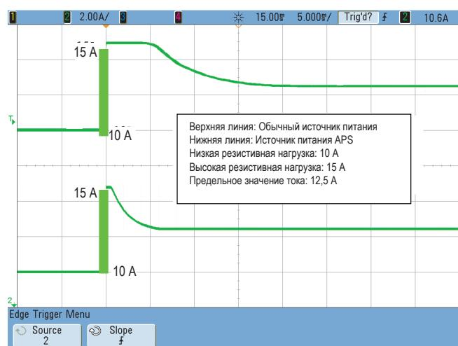
Рис. 3. Сравнение функций ограничения тока: верхняя линия – обычный источник питания, нижня – источник питания APS.
