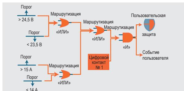
На рис. 4 показан пример интеллектуальной системы запуска APS, которая создает сигнал для запуска определенного пользователем события или специального события защиты.
