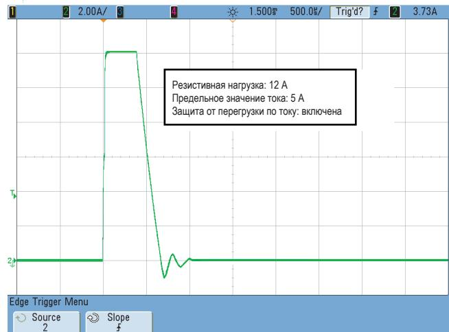
Рис. 2. Защита от перегрузки по току источника питания APS отключает выход
