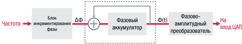
Рисунок 9. Функциональная блок-схема генератора с цифровым управлением.
