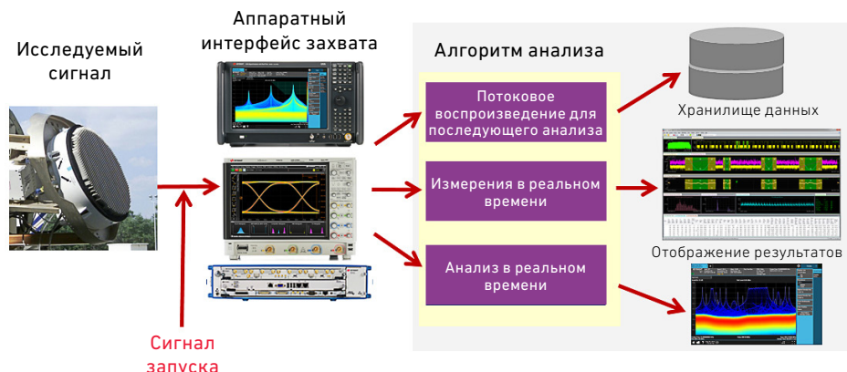
Рисунок 4. Функциональные блоки процесса измерений параметров импульсов или сигнальной обстановки. Поскольку результатом захвата сигнала является набор цифровых выборок, сигнал может быть помещен в хранилище данных для последующей (или повторной) обработки различными способами.
