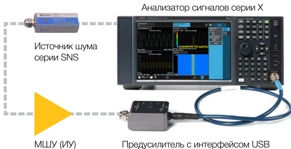
Рисунок 2. Включение интеллектуального предусилителя между ИУ и анализатором сигналов для улучшения собственного КШ анализатора. При подключении предусилитель автоматически подгружает в анализатор сигналов таблицу калибровочных коэффициентов по интерфейсу USB.
