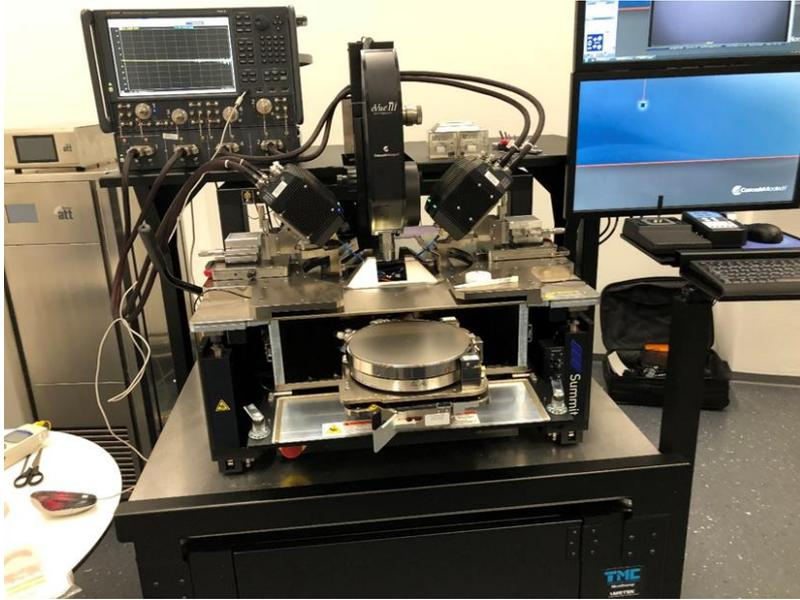
Рис. 5. Установка для измерений на полупроводниковой пластине
