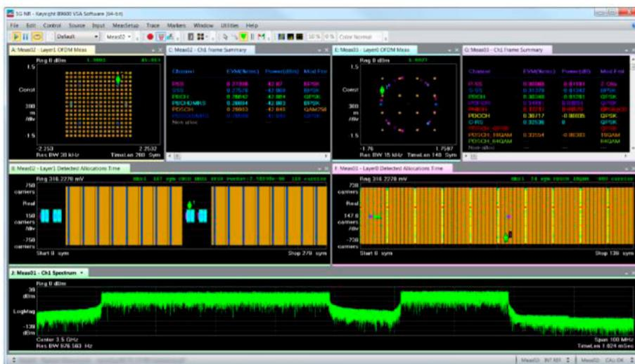
Рис 2. Испытательный стенд для формирования и анализа сигналов стандарта 5G NR используется для создания сценария сосуществования 5G и 4G LTE с целью оценки пригодности устройства
