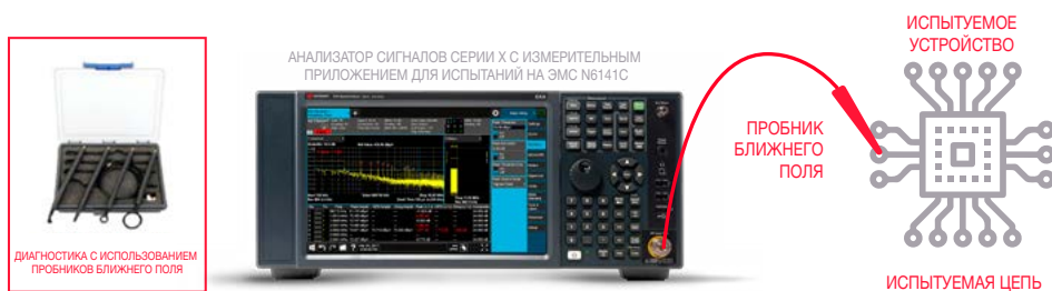
Рисунок 6. Использование пробника ближнего поля для локализации источника излучений в устройстве
