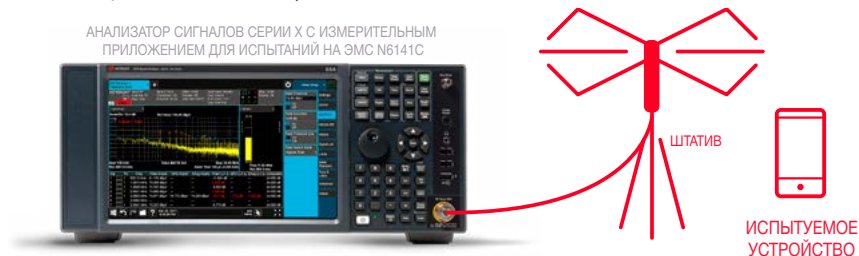
Рисунок 4. Схема измерения уровня собственных электромагнитных излучений устройства
