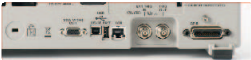
Рис. 7. У приборов серии 5000 нет последовательного интерфейса RS-232. Однако у них есть почти все прочие возможности для подключения, которые могут потребоваться — в стандартной комплектации.
