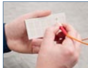
Удерживая соединитель в перпендикулярном положении, переместите его торцевую поверхность из места нанесения растворителя в сухую зону.
