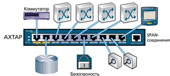
Комбинированные ответвители дублируют и объединяют трафик наиболее важных каналов передачи данных между коммутаторами/маршрутизаторами и 5 SPAN-портами на три разные системы для анализа.
