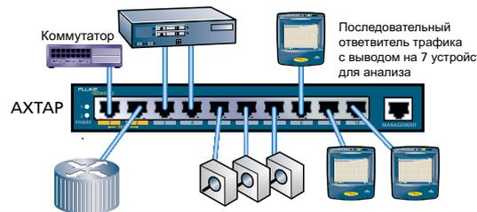
Комбинированный ответвитель дублирует трафик наиболее важных каналов передачи данных между коммутаторами/маршрутизаторами для нескольких решений для мониторинга и анализа. Некоторые получают агрегированные данные, другие – данные с полнодуплексных каналов.
