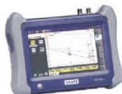
T-BERD/MTS-5800 - портативний тестер для тестування 10 G Ethernet і оптоволоконних мереж
