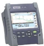
T-BERD/MTS-2000 - однослотова портативна модульна платформа для тестування оптоволоконних мереж
