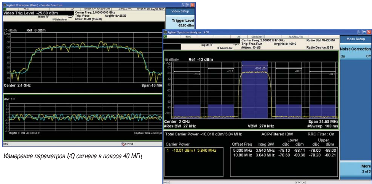
Динамический диапазон измерения коэффициента утечки мощности в соседний канал системы W-CDMA равен 78 дБ.
