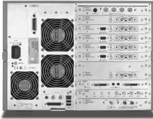
**Рис. 1.12.** Анализатор B1500A на 10 гнезд поддерживает различные типы модулей «источник/измеритель» (SMU), а также модуль для измерения емкости (CMU), модуль высоковольтного импульсного генератора (HVSPGU) и комбинированный модуль «генератор сигналов/быстродействующий измеритель» (WFGMU)
