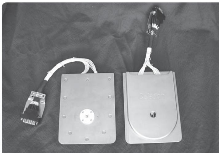
**Рис. 4.8.** Полностью экранированная керамическая плоская зонд-карта работает при температуре от  $-65\text{ }^{\circ}\text{C}$  до  $+300\text{ }^{\circ}\text{C}$  (Примечание. Фотография зонд-карты Attofast™ компании Cascade Microtech)
