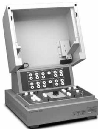
**Рис. 3.48.** Тестовая оснастка Agilent N1259А – безопасное решение для тестирования мощных устройств током до 20 А и напряжением до 3000 В
