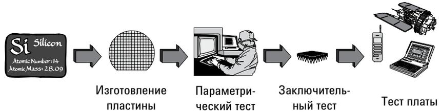
**Рис. 1.5.** Параметрический тест выполняется после изготовления пластины, но перед функциональным тестом
