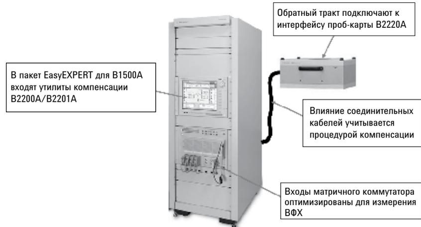
**Рис. 8.49.** Интегрированное решение Agilent для измерения ВАХ и ВФХ с помощью матричного коммутатора
