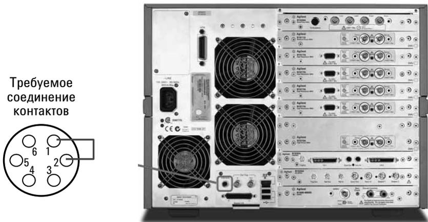
**Рис. 3.46.** Расположение защитной блокировки на задней панели B1500A
