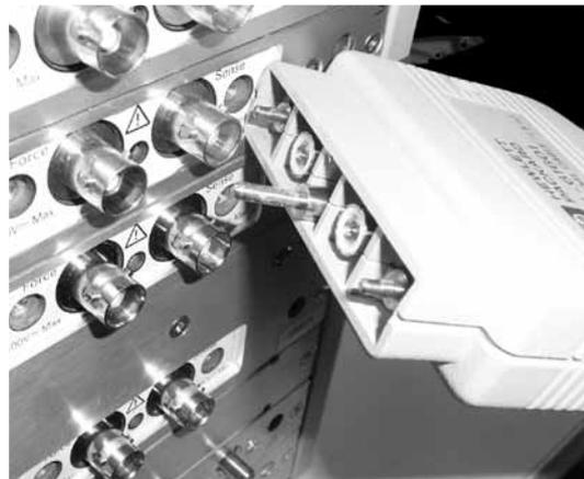
**Рис. 2.18.** Триаксиальный кабель Кельвина совместим с SMU Agilent и разнообразными панелями разъемов для зондовых станций
