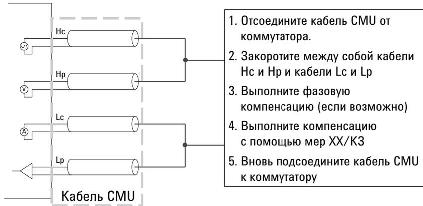
**Рис. 8.45.** Правильная процедура компенсации влияния кабелей между измерителем емкости и матричным коммутатором
