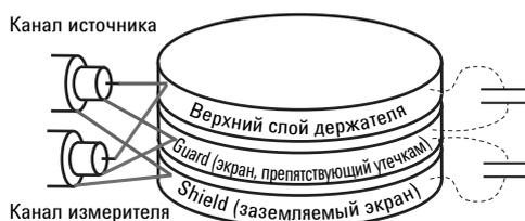
**Рис. 4.2.** Подключенный по четырехпроводной схеме Кельвина держатель пластин со слоем Guard-экрана позволяет исключить влияние собственной паразитной емкости и существенно снизить емкостной ток утечки через внешнюю среду
