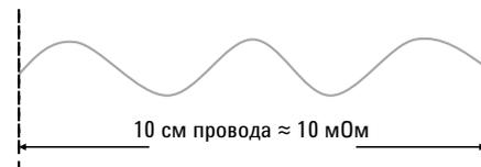
**Рис. 3.45.** Простой способ получить резистор 10 МОм – использовать небольшой отрезок провода
