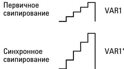
**Рис. 3.37.** Функция синхронного свипирования позволяет определенному SMU отслеживать первичный источник свипирования с учетом коэффициента, заданного пользователем
