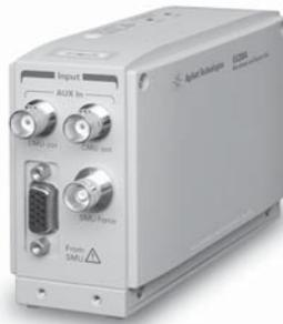
**Рис. 4.18.** Входы ASU: два коаксиальных (сверху), триаксиальный (от линии источника HRSMU, правый нижний) и вход кабеля управления (также подводится от HRSMU, левый нижний).
