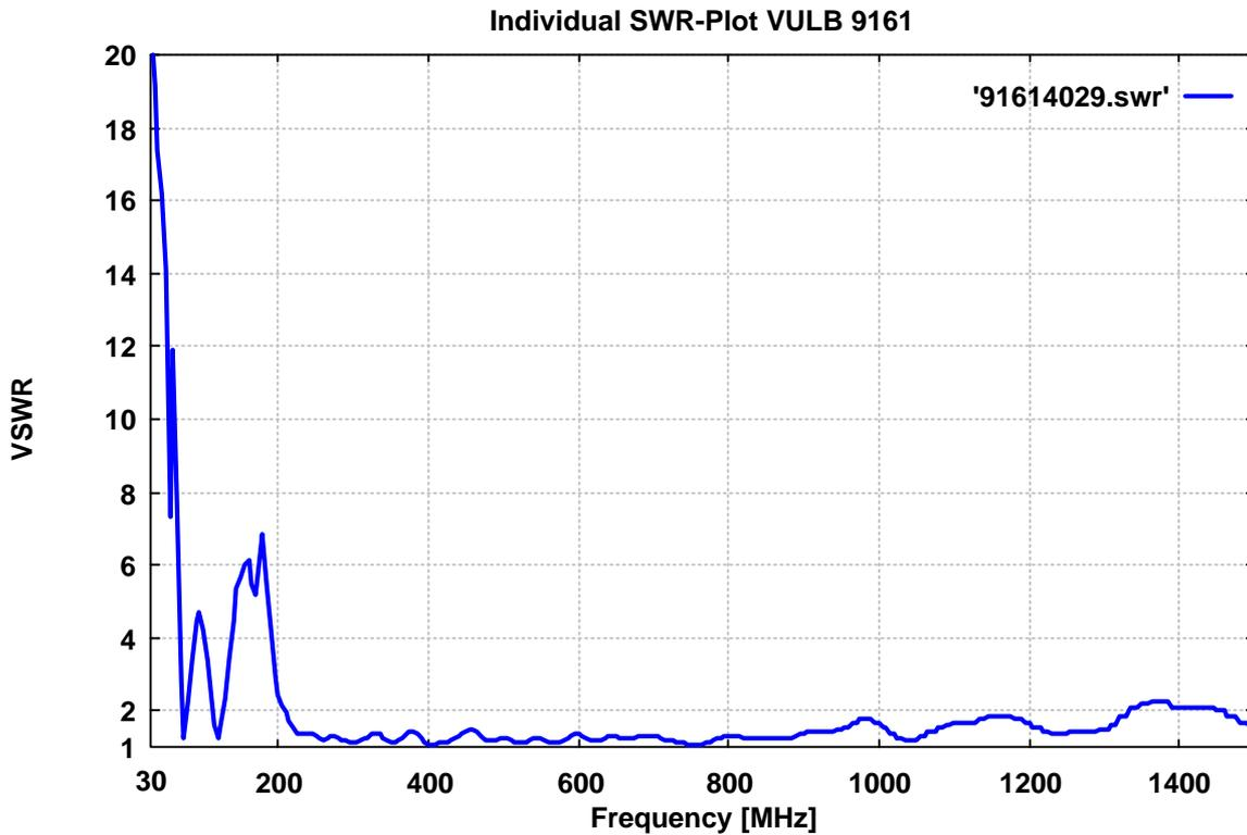
Zwischenschalten eines Dämpfungsgliedes ist zweckmäßig, wenn das angeschlossene Gerät ein hohes Eigen-SWR (z.B. in der 0 dB-Stellung des Eingangsteilers) aufweist. Dann ist diese Dämpfung zum Antennenwandlungsmaß zu addieren bzw. vom Gewinn abzuziehen.
